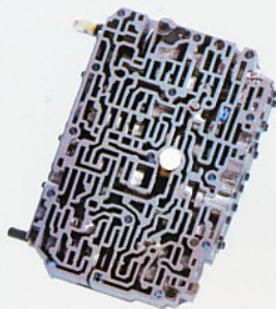
Le bloc-valves est le « cerveau » de la boîte automatique.
