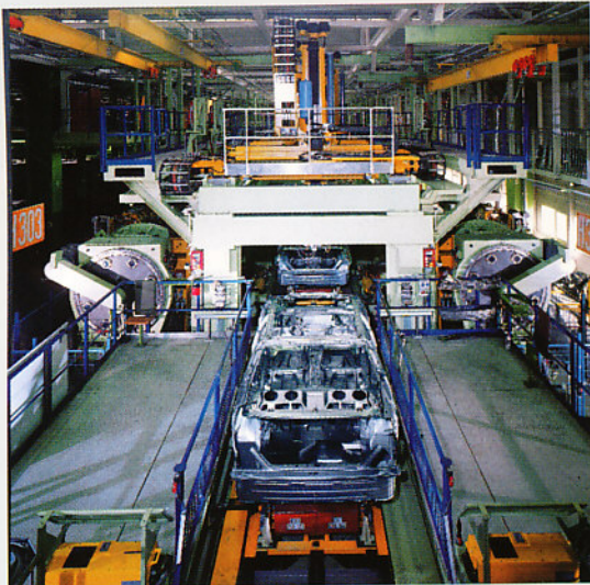
Une chaîne de production flexible pour l'assemblage des carrosseries à Sindelfingen, près de Stuttgart.
